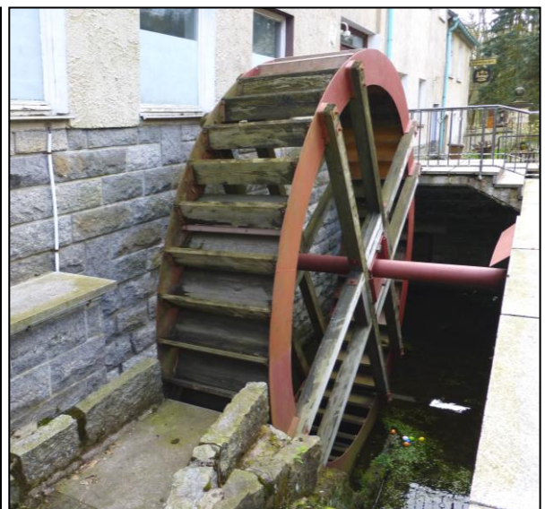
Links das originale alte unterschlächtige Hüttertermühlen-Wasserrad mit den gebogenen Blech-schaufeln, rechts der nicht originalgetreue Nachbau von 1979 als (fast) mittelschlächtiges Rad mit den Wasser-Zellen und dem zur Funktions-Simulation höher gelegten Wasserzulauf
